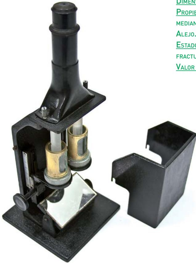
Se trata de un colorímetro Duboscq (de fabricación americana, de la marca Bausch y Lomb). Fue empleado durante el siglo XIX hasta la primera mitad del siglo XX, como “un instrumento para medir la profundidad del color en un líquido por comparación con un líquido estándar de la misma tinta.”<sup>89</sup>
